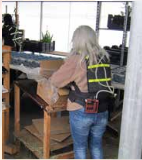
Personengetragene Messung von Stäuben im Versand einer Staudengärtnerei
