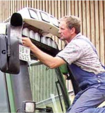
▲ Der Aktivkohlefilter muss nach Herstellerangaben ausgetauscht werden.
