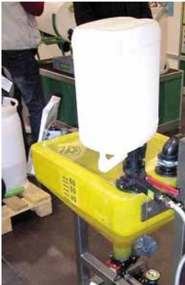
◀ Für Kleingebinde bis 20 l bietet die Industrie ein Universalkanister-Einfüllsystem, mit dem der Spritzmittelkanister und das Spritzgerät sicher und tropffrei verbunden werden können. Hierbei gelangt das Pflanzenschutzmittel direkt in das Pflanzenschutzgerät und der Kanister wird abschließend gespült.
