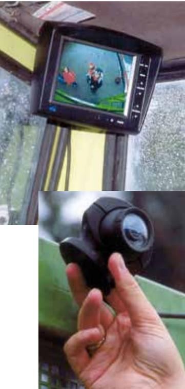
Um nicht einsehbare Gefahrenbereiche beobachten zu können, ist der Einsatz von Überwachungskameras zu empfehlen.
