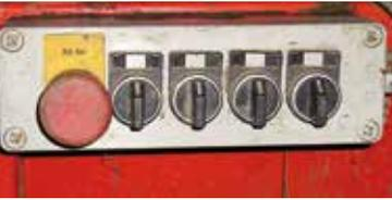
▲ Arbeitsplätze an elektrisch betriebenen Maschinen müssen mit einem Not-Aus-Schalter zum Stillsetzen der Anlage ausgestattet sein.
