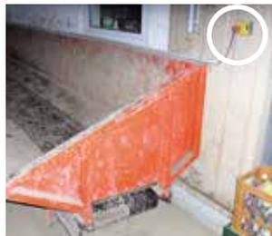
◀ Der NOT-AUS-Schalter an dieser Abladeeinrichtung ermöglicht im Gefahrenfall ein Abschalten der Anlage unabhängig vom Netztrennschalter.
