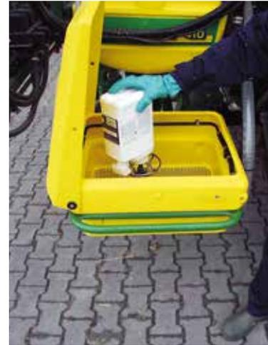
Dies verhindert z. B. eine Einspülschleuse mit integrierter Spüleinrichtung, ein Standard an allen Neugeräten. Für die Nachrüstung älterer Geräte werden technische Lösungen angeboten.
