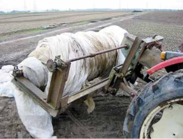
Einzugsstellen an drehenden Teilen, Quetsch- und Scherstellen sowie fehlende Not-Aus Schalter sind oft der Grund für schwere Unfälle!
